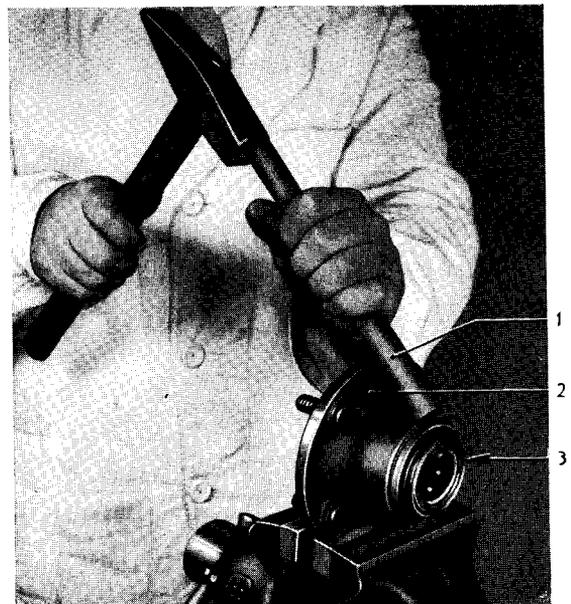
Bild 19 – Dichtring herauschlagen
