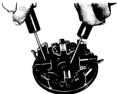
Bild 61 – Isolierten Bürstenhalter auf Masseschluß prüfen
