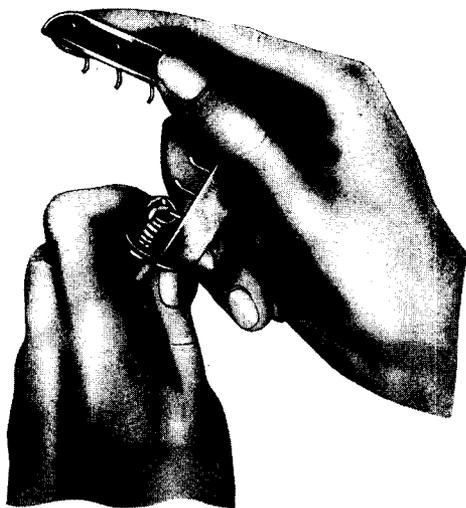
Bild 45 – Elektrodenabstand prüfen
