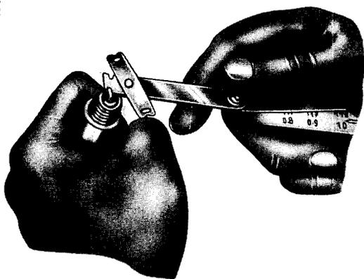
Bild 46 – Elektrodenabstand nachstellen
